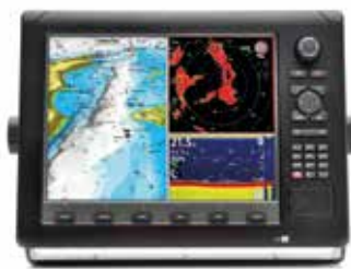
Netværksplotter med Broadband radar og ekkolod samt NMEA2000 integration af motordata m.m.
