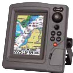
Eksempel på en søkortplotter med GPS
